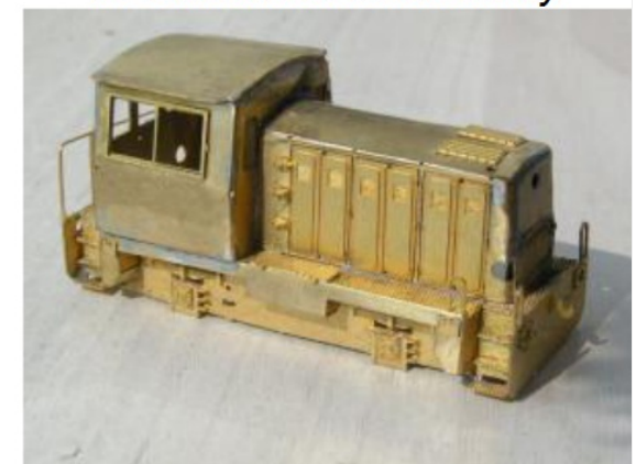
vyleptaný mosazný plech se stavebnicí lokomotivy
